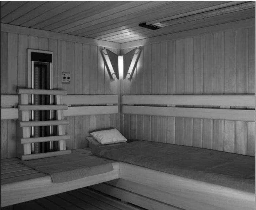
Einbau eines 500 Watt Strahlers in die Seitenwand mit Holzverkleidung (links) und eines 1300 Watt Strahlers an der Decke (rechts oben).
